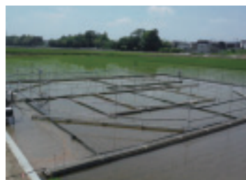
茨城県つくばみらい市にあるFACE実験施設。水田に設置したチューブで[CO 2 ]を調節する。
