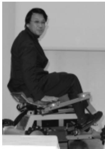
特殊な車輪を用いることで前後左右の移動を可能とし、座席の上下動が電動で同時に行える車いす「4ch(ヨンちゃん)」に乗って実演した。写真。
