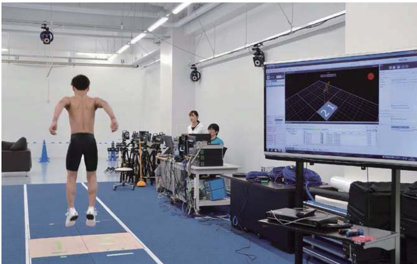
モーションキャプチャーを付けた学生がフォースプレートと呼ばれる測定板の上でジャンプすると、リアルタイムで3次元データが表示、分析レポートが生成される
