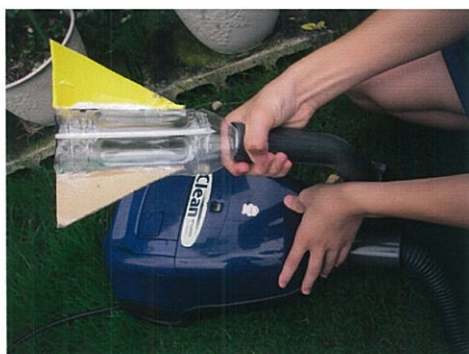
図2 掃除機で換気し（左），機械式ピペットで正確に燃料を注入する（右）
