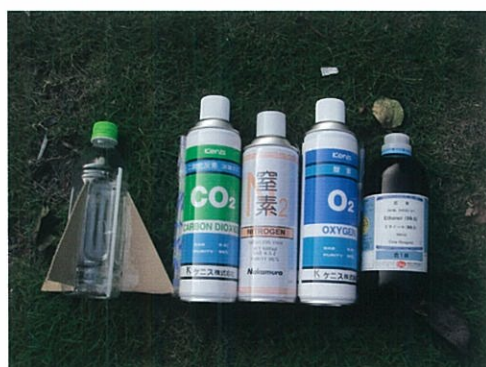
図5 各種ガスと表6用の三枚翼機（左），表の番号9では爆発で底が破れた（右）
