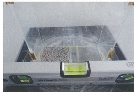
図5 粒が片部屋に集まった状態でも両部屋が水平であることを確かめた。
