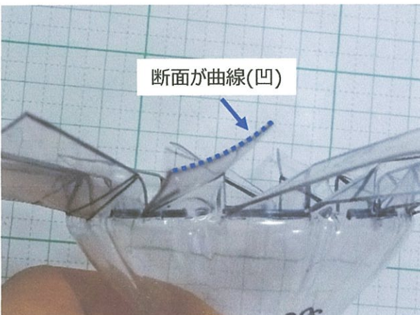
写真8 通常の羽根の断面
