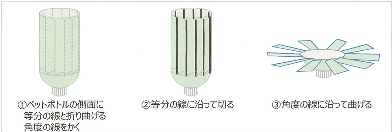
図2：ペットボトル羽根の作製方法
