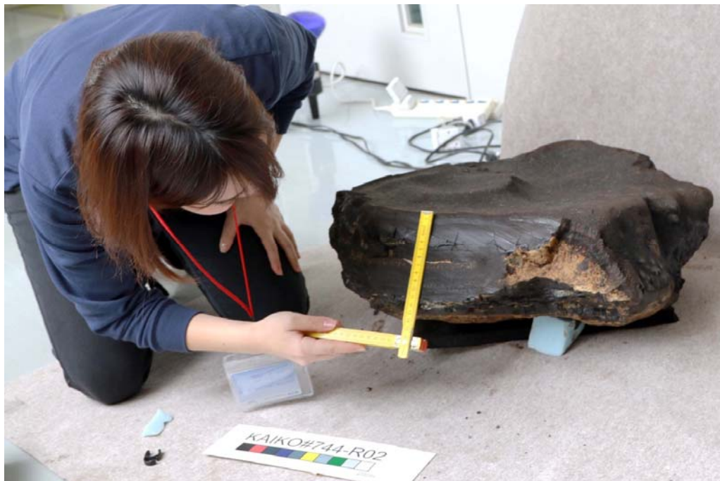
図4：水深3200m付近の厚さ約13cmのコバルトリッチクラストの写真
