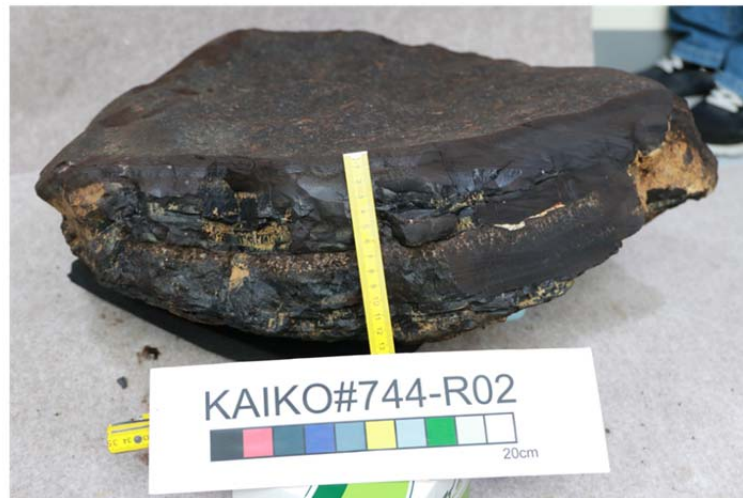
図3：各水深におけるコバルトリッチクラストの写真（岩石の黒い部分がコバルトリッチクラスト）
