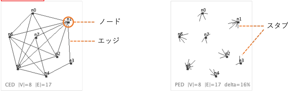
図1: 従来手法による連結図(左)と、これに部分エッジ描画を適用したもの(右)。連結図はノードの集合とそれをつなぐエッジ(リンク)の集合で構成される。部分的に描かれたエッジをスタブと呼ぶ。
