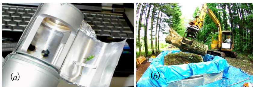
図 1. (a)木本植物の芽生えの呼吸測定の様子、(b)大木（樹高 34m）の幹を呼吸測定装置に入れる様子 大木は 8m 3 の装置で数回に分けて測定し、測定値を足し合わせて個体呼吸としました。植物のサイズに合わせて様々な大きさの装置で測定しますが、測定原理と CO 2 センサーは統一しました。
